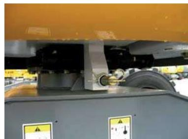
Контактный замок поворота (Пожалуйста, смотрите конфигурацию подъемника)
