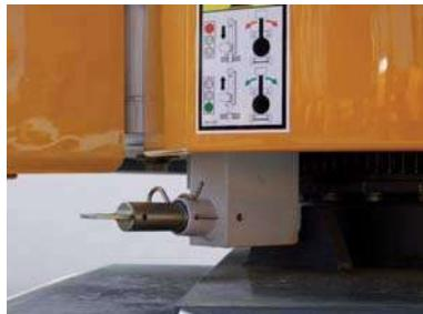
Контактный замок поворота (Пожалуйста, смотрите конфигурацию подъемника)
